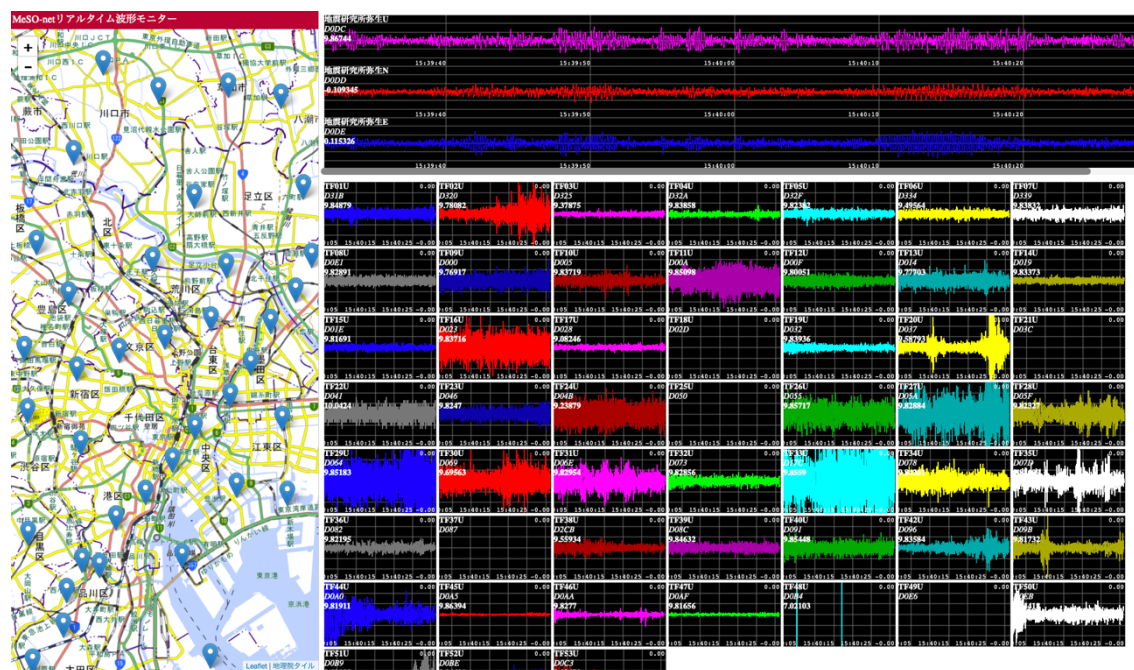
図 2.地震活動モニタリングにおける複数観測点のリアルタイム波形表示例。
