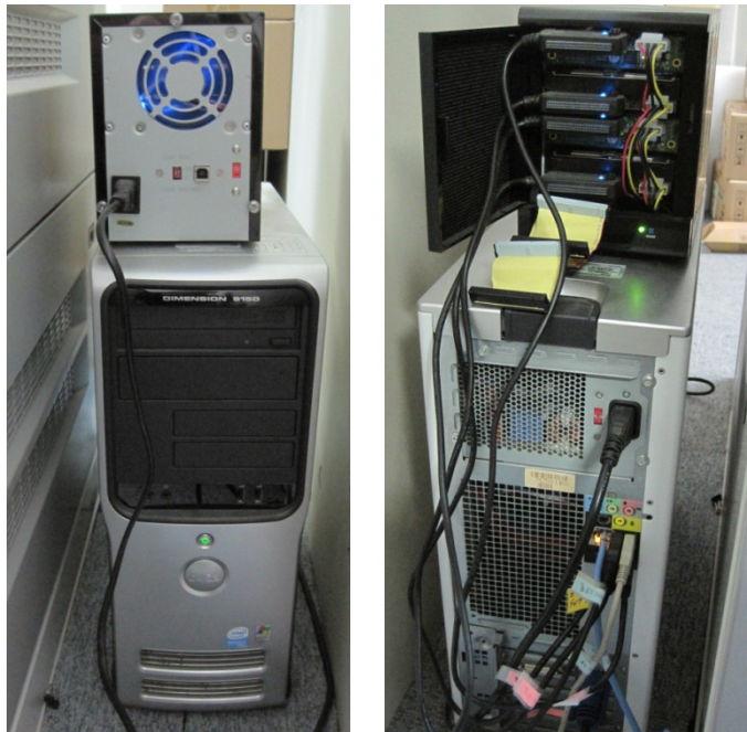
図1 地震波形受信PCの表面（左）と裏面（右）。PCの上に乗っているのが外付けHDDのボックスで、4個のHDDがPCに接続されている。右図下の青いケーブルが、Bフレッツ接続用ケーブルである。
